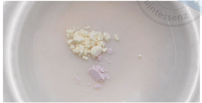
Abb. 7 Malfarbe zum Charakterisieren des Zirkonoxidkappchens.
